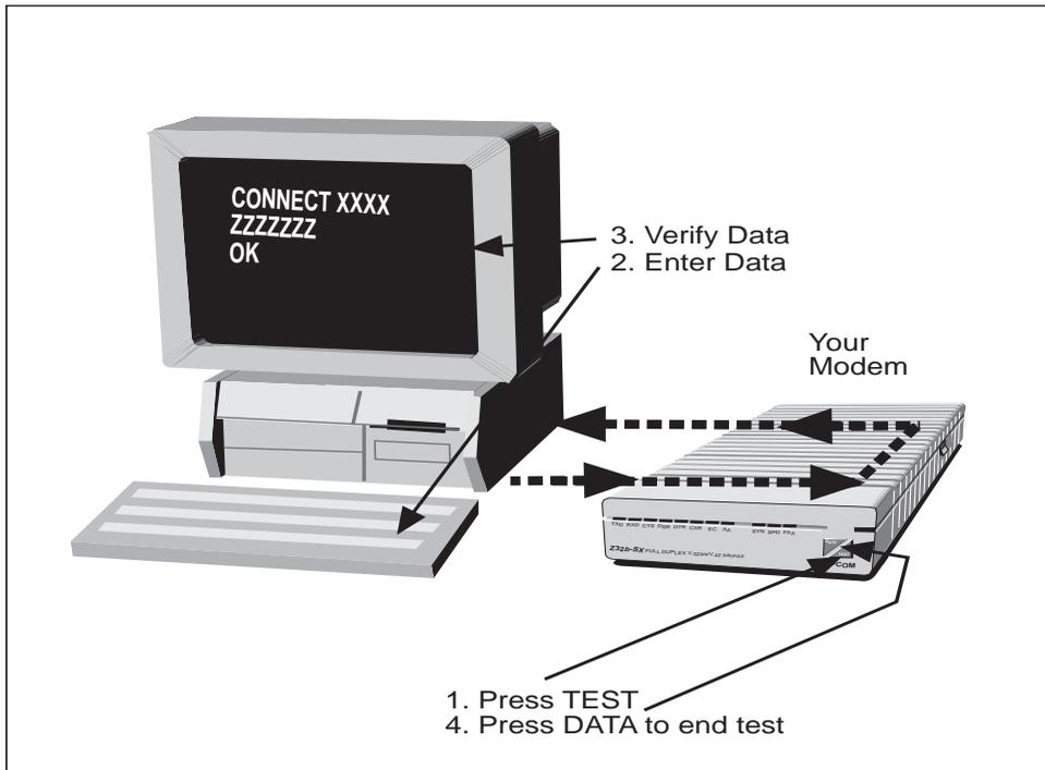
*Figure 10-2. Analog Loopback Data Test*
